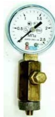
Фото 7. Цилиндр съёмника с подвижным фланцем Фото 8. Манометр с краном Маевского
