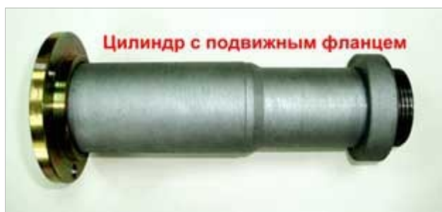
Фото 7. Цилиндр съёмника с подвижным фланцем Фото 8. Манометр с краном Маевского
