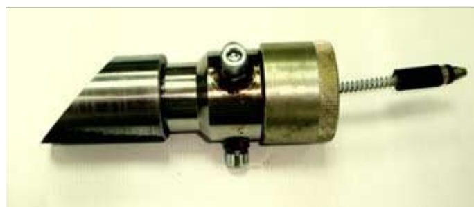
Фото 4. Бобышка-переходник с ПЭП-3-65 со штатным держателем
