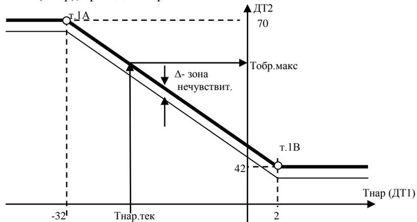
Рис. 4-1. График Тобр. макс =  $f(T_{нар})$
