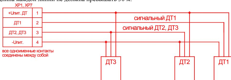
Рис.7-2. Подключение электронных термопреобразователей.
