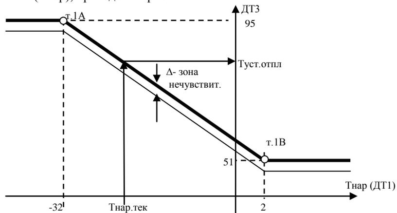
Рис. 4-2. График Туст.отпл =  $f(T_{нар})$
