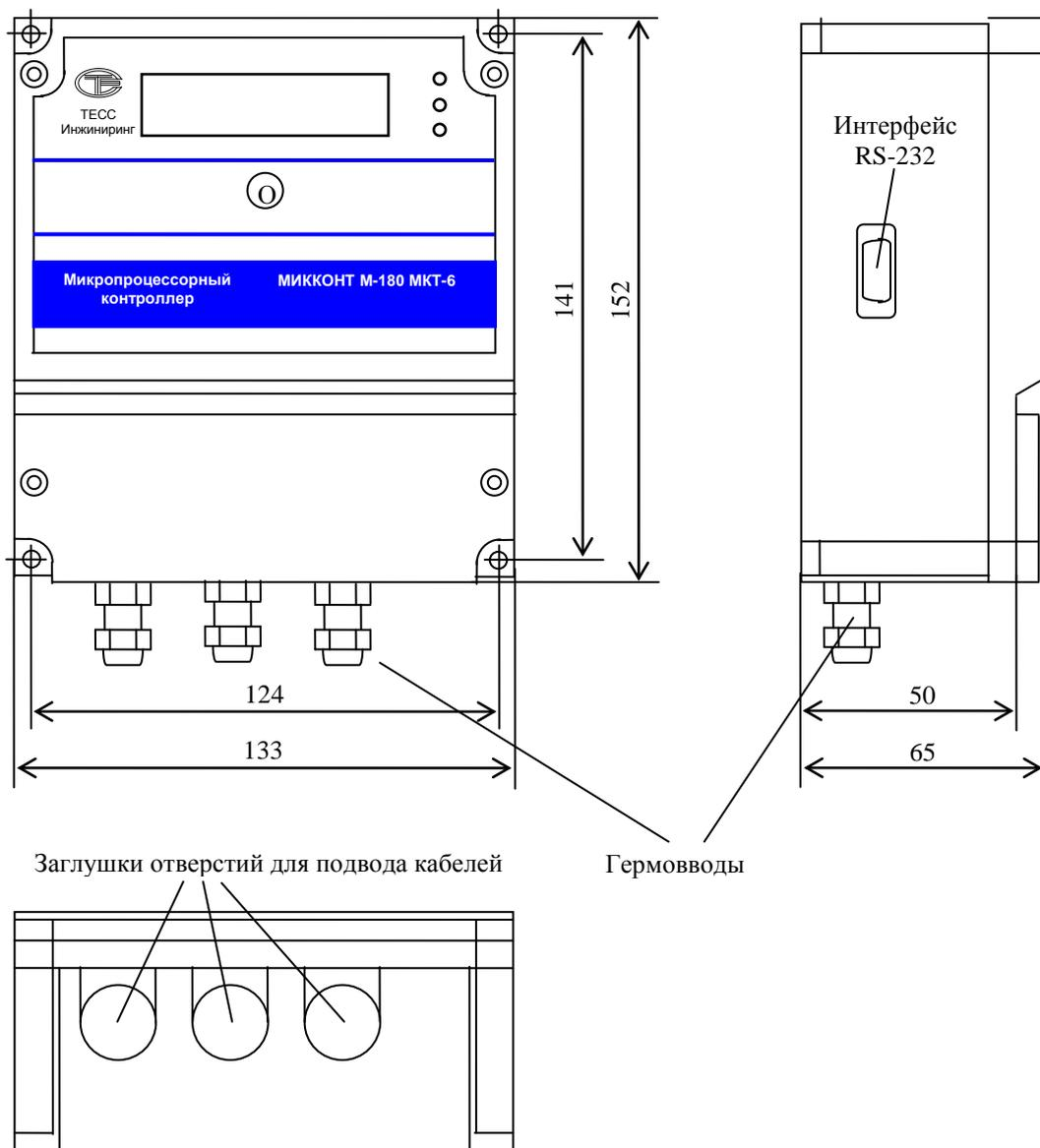
Рисунок Б-1. Габаритные и установочные размеры
